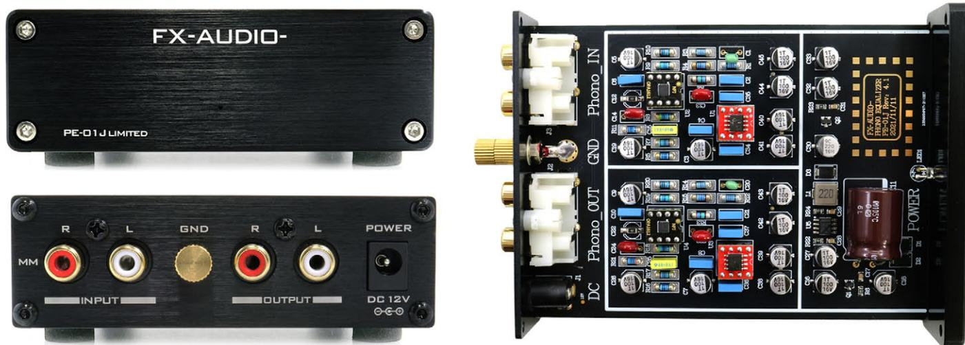
MMカートリッジ対応フォノイコライザーのスタンダードモデル「PE-01J」をベースに、高精度MELF型抵抗や積層型メタライズドポリエステルフィルムコンデンサといった高音質部品の採用を踏襲し、回路設計はそのままにさらなる音質向上を目指して、部品選定に一層のこだわりを加えた特別限定モデルです。
