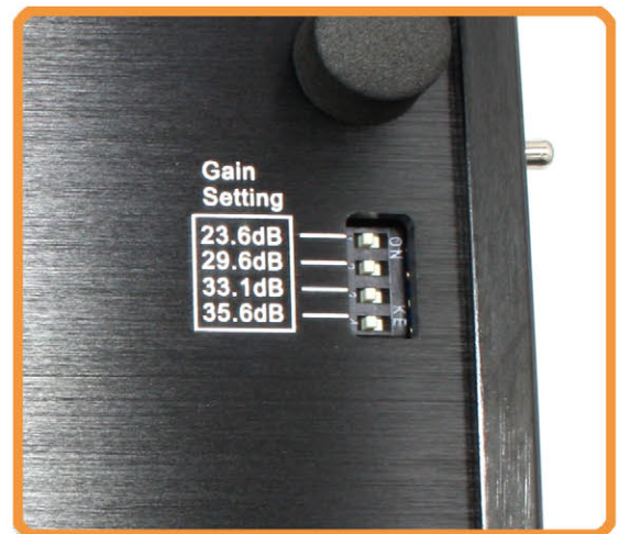
本体裏面ゲイン設定DIPスイッチ
